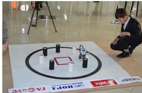
датчиком освещённости, расположив его на кронштейне слева от корпуса в передней части тележки. Программа управления составлена из двух частей: в первой части задано движение по круговой дуге с выходом тележки от центра к внешнему краю, вторая часть программы обеспечивает движение тележки вдоль окружности с контролем чёрной линии.
